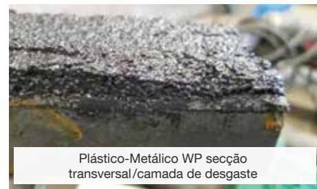
WEICON WP – Reparação e proteção contra abrasão, de um britador
