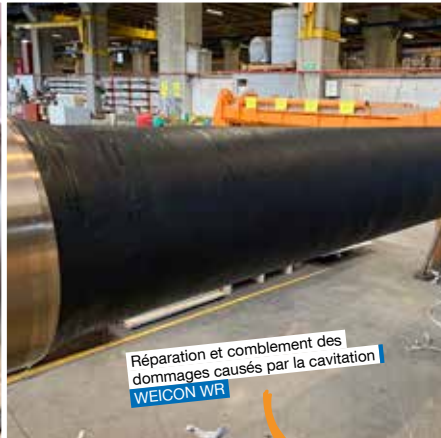
Réparation d'un arbre de propulsion de navire
