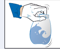
Tamir Bandını temiz suya batırın ve Tamir Bandını sızıntının etrafına sarın.
