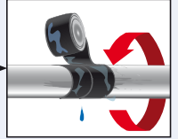
Tamir Bandını temiz suya batırın ve Tamir Bandını sızıntının etrafına sarın.
