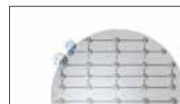
L'oxygène et l'humidité démarrent l'oxydation.
