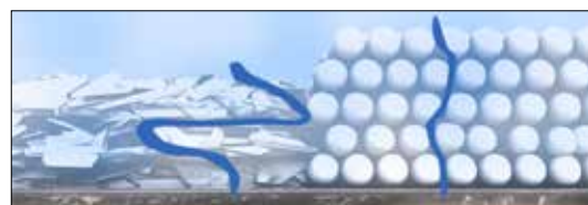
Voies de diffusion à travers la couche de zinc.
