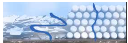
Diffusionswege durch die Zinkschicht.
