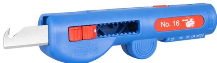
Entmanteln und Abisolieren aller gängigen Rundkabel von 8 - 13 mm  $\varnothing$ , Hakenklinge und Abisolierbereich sind integriert. Schneller und einfacher Längsschnitt durch optimierte Kabelführung im Gehäuse.
