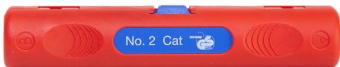
Der Stripper No. 2 Cat sorgt für ein sicheres und komfortables Entmanteln aller isolierten PVC-Datenkabel (z.B. Cat5, Cat6, Cat7, Twisted-Pair-Kabel) mit einem Durchmesser von 4,5 - 10 mm. Eine Einstellung der Schnitttiefe ist nicht erforderlich. Die präzise Klingeneinstellung setzt die Außenisolierung optimal ab. Mit der zweiten Klinge wird die Folienschirmung passgenau angeritzt und kann einfach entfernt werden.
