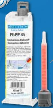
WEICON Easy-Mix PE-PP 45 由于粘度较高，能轻松填充最大为 1 mm 的粘接缝隙。同时，由于胶粘剂中含有填充物（玻璃微珠），其最小粘接缝隙为 0.20 mm。
