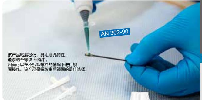
该产品粘度极低，具毛细孔特性，能渗透至螺纹细缝中，因而在拆卸螺栓的情况下进行锁固操作。该产品是螺纹事后锁固的最佳选择。
