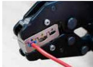
**ERGO 压接钳 新品****通用型人体工学压接钳，适用于多种电气连接方式**
