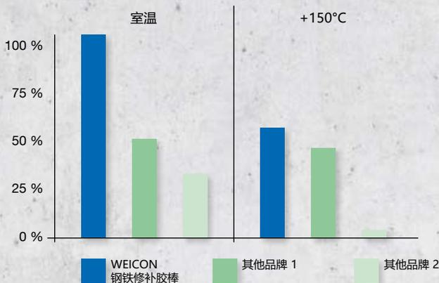
钢铁修补胶棒的粘接强度
