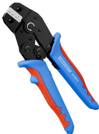
Die Crimpzange MULTI wurde für das prozesssichere Crimpen verschiedener elektrischer Steckverbinder entwickelt. Die Zange besitzt einen Ratschen-Mechanismus mit Zwangssperre für gleichbleibend hohe Crimpqualität und ein wiederholgenaues Arbeiten. Der Mechanismus öffnet die Zange erst dann, wenn der Crimpprozess vollständig abgeschlossen ist. Zusätzlich wurde eine Notentriegelung im Griff integriert, die die Zange im Fall einer Fehlanwendung wieder öffnet.
