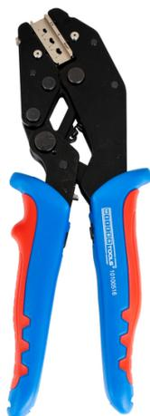
Die Crimpzange ERGO wurde für das prozesssichere Crimpen verschiedener elektrischer Steckverbinder entwickelt. Die Zange besitzt einen Ratschen-Mechanismus mit Zwangssperre für eine gleichbleibend hohe Crimpqualität und für wiederholgenaues Arbeiten. Der Mechanismus öffnet die Zange erst, wenn der Crimpprozess vollständig abgeschlossen ist. Zusätzlich ist eine Notentriegelung im Griff integriert, die bei Bedarf, wie z. B. einer Fehlanwendung, die Möglichkeit bietet, die Zange wieder zu öffnen.
