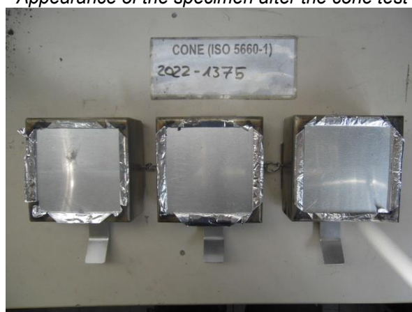
Aussehen der Proben nach dem Cone Versuch Appearance of the specimen after the cone test
