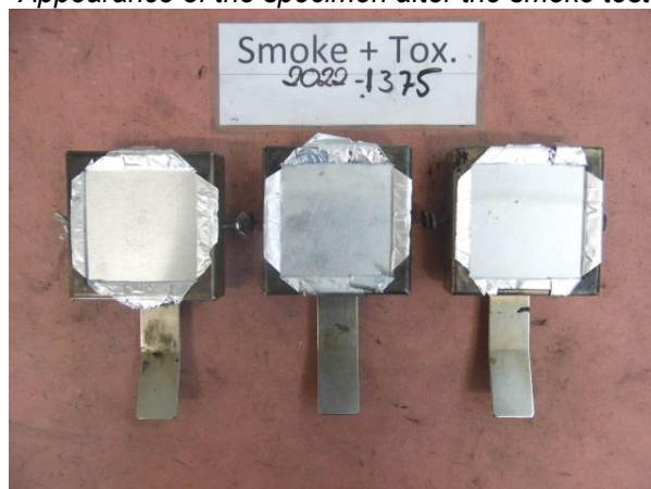
Aussehen der Proben nach dem Rauchdichteversuch Appearance of the specimen after the smoke test
