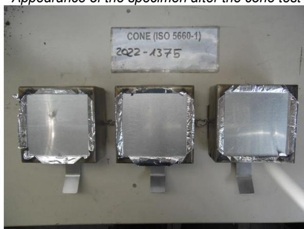
Aussehen der Proben nach dem Rauchdichteversuch
