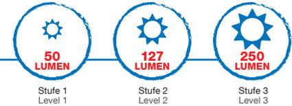
Schalter **1** einmal drücken für ON, für die drei Helligkeitsstufen je ein weiteres Mal drücken und für OFF den Schalter länger drücken. Das LED Work Light ist so programmiert, dass beim Einschalten Helligkeitsstufe 2 aktiviert ist.
