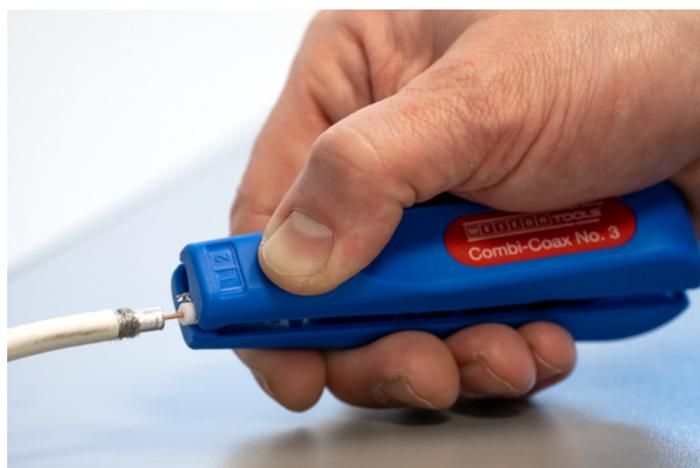
Le Combi-Coax N°3 permet de dénuder progressivement tous les câbles coaxiaux, câbles NYM et câbles souples courants. Le réglage de la profondeur de coupe n'est pas nécessaire. Le dénudeur Combi-Coax No. 3 dénude les câbles coaxiaux d'un diamètre de 4,8 à 7,5 mm, les câbles NYM de 3 x 0,75 mm<sup>2</sup> et les câbles flexibles de 10 et 16 mm<sup>2</sup>.
