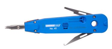
Le Palpeur N° 40 permet de raccorder des conducteurs d'un diamètre de 0,35 - 0,9 mm et des brins d'un diamètre de 0,7 - 2,6 mm à des bandes ou blocs LSA. En appliquant une légère pression sur l'outil, les fils sont connectés et coupés en une seule opération. Il n'est pas nécessaire de dénuder ou de visser manuellement.
