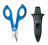
Les ciseaux servent à couper et dégainer des fils Cu/Al et pour sertir des embouts de 0,5 à 4 mm². Les lames en acier INOX de haute qualité sont trempées à 55 HRC et donc très résistantes à l'usure. La micro-denture fine des lames permet une coupe à fleur et antidérapante, ce qui donne une coupe très précise. Les poignées antidérapantes à 2 composants en plastique renforcé de fibres de verre résistant aux chocs garantissent un travail en toute sécurité.
