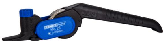
Le coupeur de la gaine extérieur No. 25 est conçu pour le dénudage des câbles jusqu'à une épaisseur de gaine de 5 mm. Le couteau peut être utilisé aussi bien pour des coupes longitudinales que circulaires. La coupe ronde peut être effectuée sur des câbles d'un diamètre extérieur de 25 mm ou plus. Le découpage de l'isolation extérieure se fait par de petits mouvements de levier et par pression simultanée de la denture sur l'isolation.
