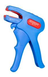
WEICON Pince à dénuder No. 7-F convient particulièrement bien aux câbles plats de 2 à 3 fils à isolation PVC de 0,75 à 4,0 mm². L'outil dispose d'un réglage fin multi-ajustable. La pince dispose d'une échelle de longueur visuelle de 8 à 24 mm. Un coupe-fil latéral bien accessible est intégré dans l'outil, utilisable pour des câbles jusqu'à 3 mm Ø. Lames échangéables.
