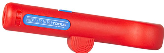
Le Cat-Cable Stripper N° 10 permet de dénuder de manière sûre et pratique tous les câbles de données et de réseau courants d'un diamètre de 4,5 à 10 mm (par exemple Cat.5, Cat.6, Cat.7, paire torsadée). La profondeur de coupe ne doit pas être réglée manuellement.
