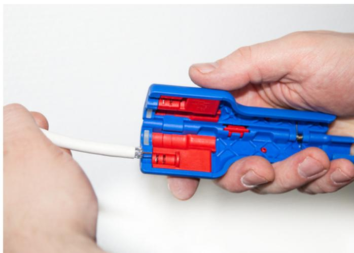
Le travail avec les outils à dénuder WEICON n'est autorisé que sur des câbles et des conduites hors tension, exempts de potentiel.
