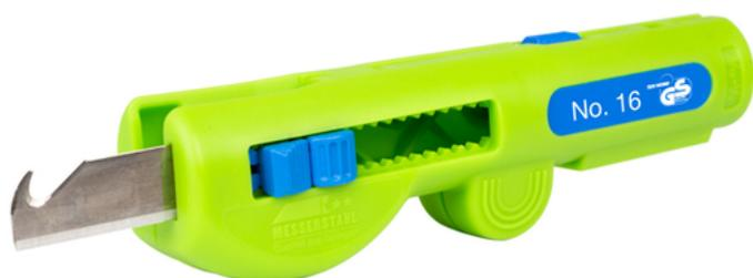
Dénudage et dégainage de tous les câbles ronds courants de 8 à 13 mm de  $\varnothing$ , la lame du crochet et la zone de dénudage sont intégrés.
