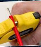
Remarque : Le travail avec les outils à dénuder WEICON n'est autorisé que sur des câbles et des conducteurs sans potentiel et non sous tension.
