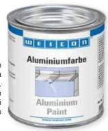
Au contact de l'humidité, les pigments d'aluminium forment une couche superficielle d'oxyde dense, pratiquement imperméable. Cette couche passivante, qui peut atteindre 0,05 µm d'épaisseur, empêche l'humidité de pénétrer plus profondément dans le revêtement. Elle protège ainsi efficacement la surface de la pièce à travailler contre la corrosion. L'utilisation de pigments non-feuillants donne une forte résistance à l'abrasion et de garantit une longue durabilité de la couleur.
