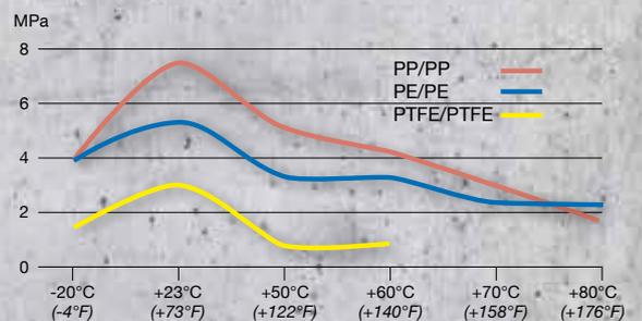
Évolution de la résistance de WEICON Easy-Mix PE-PP 45 sur des éprouvettes de cisaillement sous traction selon DIN EN 1465
