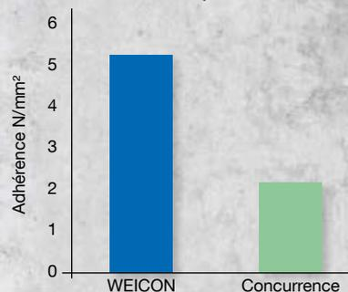
Les adhésifs époxy WEICON sont des systèmes bicomposants sans solvant, à pouvoir adhésif extrêmement fort, durcissant à froid. Ils permettent des collages présentant une forte résistance à la traction et aux chocs, ce qui les rend idéaux pour l'assemblage, la réparation et la production.
