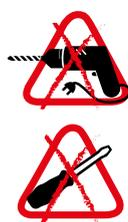
Pour obtenir un résultat de montage optimal, il faut des surfaces à coller propres (nettoyant de surface), sèches et si possible lisses. La température de mise en oeuvre devrait dépasser 10°C lors de l'application. Le ruban de montage ne convient pas à l'utilisation sur des papiers-peints et d'autres surfaces sensibles, car il pourrait alors endommager le substrat lors du décollage.
