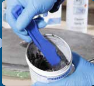
Bien mélanger la résine et le durcisseur sans bulles
