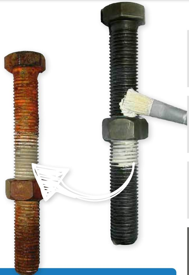
Grâce à la composition particulière et à l'extrême finesse de la poudre de matières solides que contient WEICON Anti-Seize, les rugosités de la surface à protéger sont entièrement remplies, même si l'épaisseur du film n'est que de 12 µm. En effet, seule une surface entièrement fermée garantit une protection efficace contre la corrosion. Dans le cas d'applications spéciales, comme sur les assemblages à brides, il en résulte un effet isolant supplémentaire.
