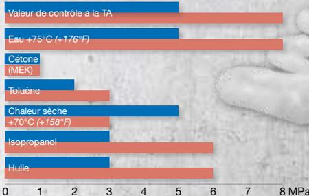
Spécification des éprouvettes:
