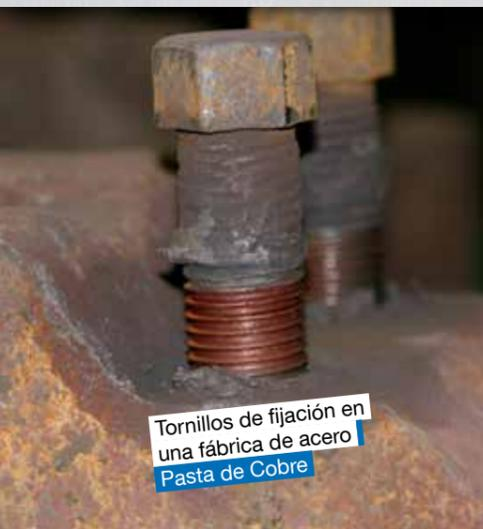
Tornillos de fijación en una fábrica de acero
