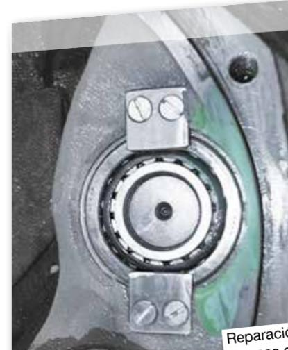
Reparación de una carcasa de transmisión
