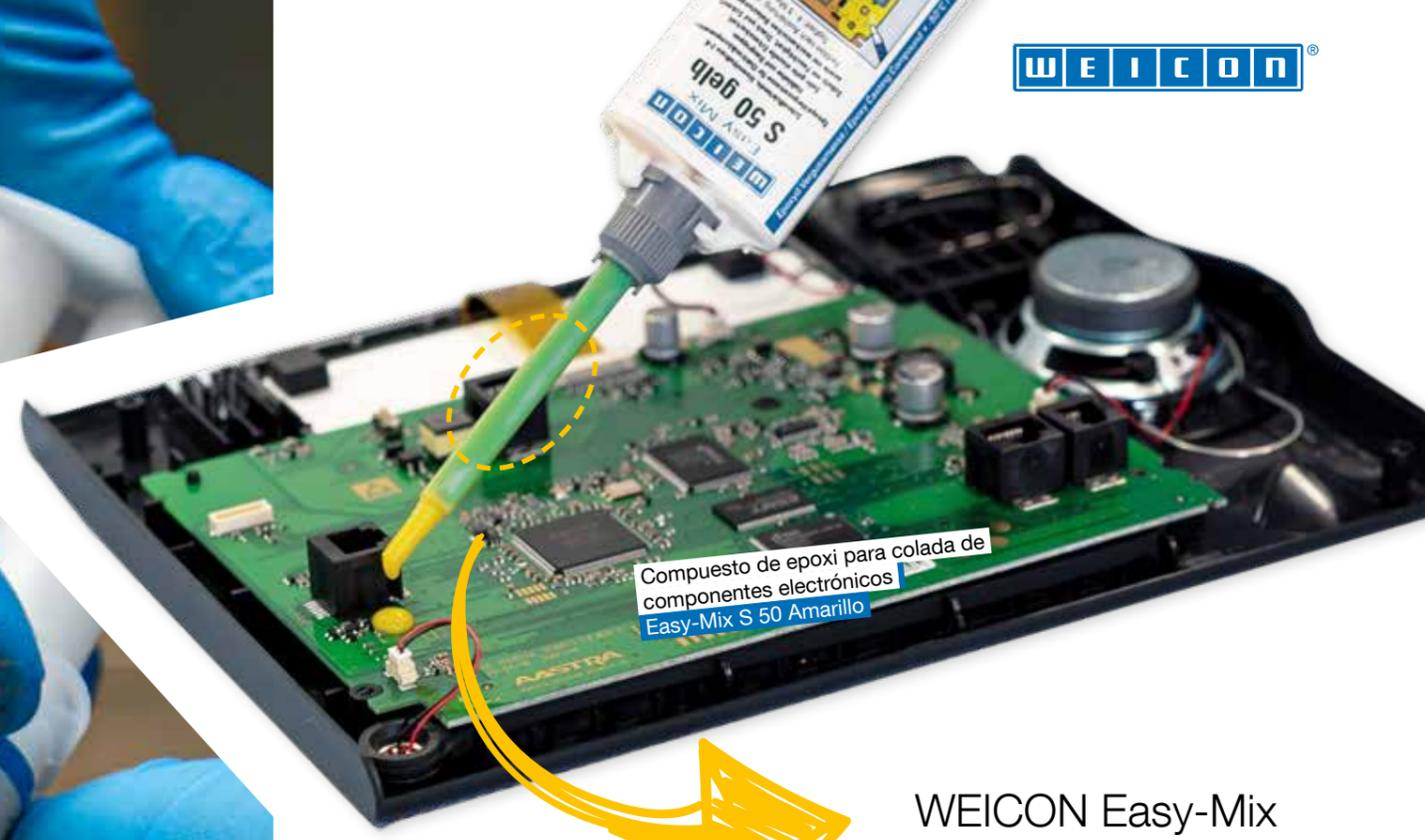
Compuesto de epoxi para colada de componentes electrónicos
