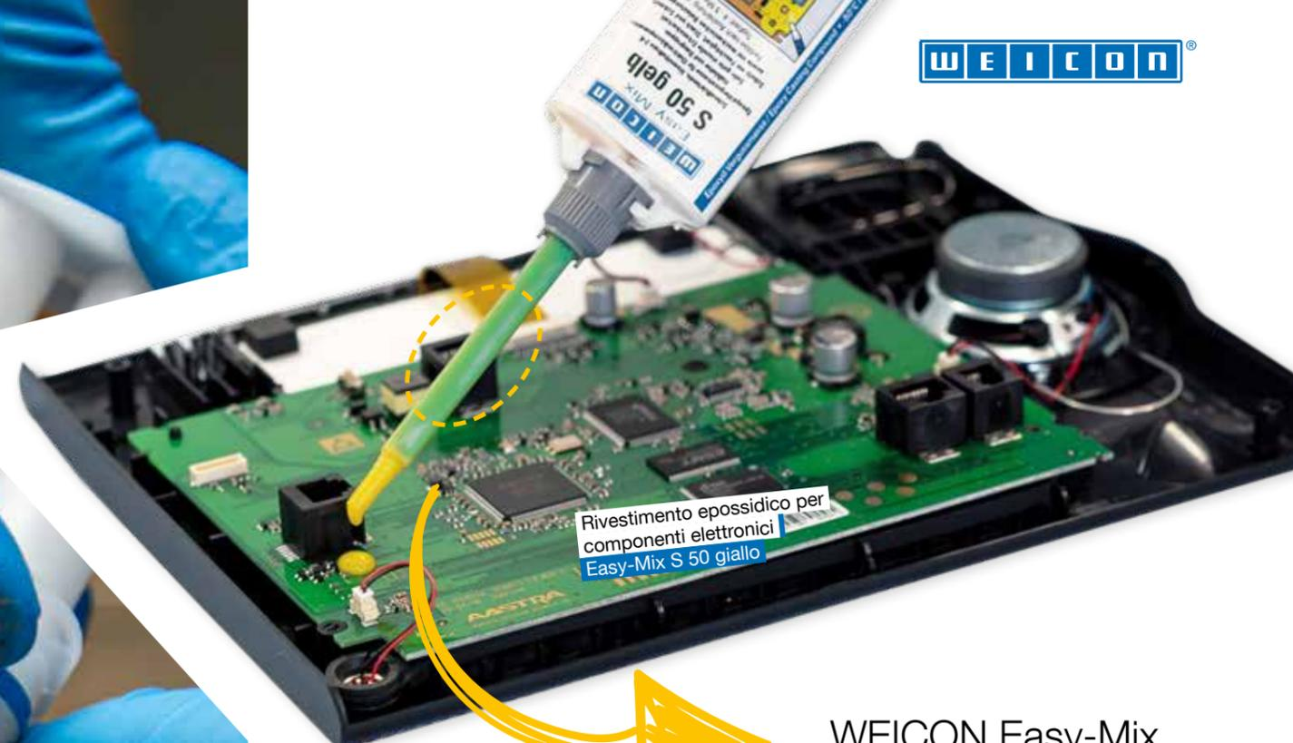
Rivestimento epossidico per componenti elettronici
