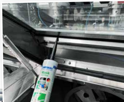
Colagem e vedação de uma tampa de vidro (máquina de processamento de azeitonas)
