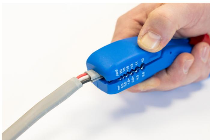
Le travail avec les outils à dénuder WEICON n'est autorisé que sur des câbles et des conduites hors tension, exempts de potentiel.
