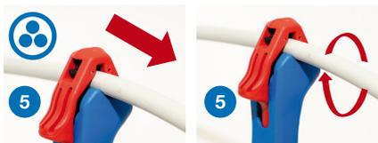
**Rundkabel:** Rund- und Längsschnitt bei längeren Strecken lassen sich durch das drehbare Innenmesser in einem Arbeitsgang durchführen (Arbeitsbereich Ø 6 -13 mm).
