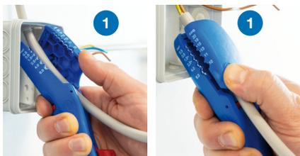
Kabel kann bei Bedarf durch das Werkzeug durchgeführt werden, sowohl bei Flach- und Rundkabel.
