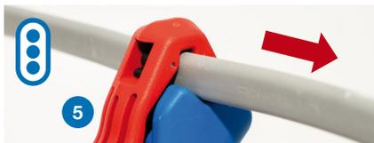
**Flachkabel:** Längsschnitt bei längeren Strecken – das Kabel wird oben und unten geführt.
