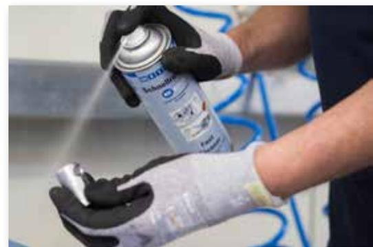
desengorduramento de superfícies que vão ser coladas ou vedadas com os WEICON adesivos e vedantes ou revestidas com os sprays metálicos WEICON.
