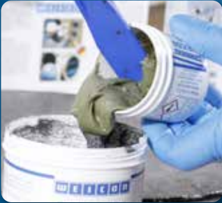
adição do endurecedor à resina
