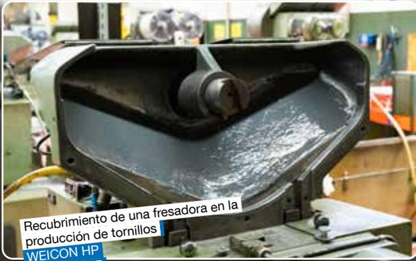
Recubrimiento de una fresadora en la producción de tornillos
