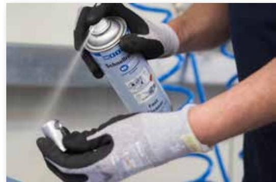
El Limpiador Rápido se emplea también para limpiar y desengrasar superficies que deben ser pegadas o selladas con selladores y adhesivos de WEICON o que se deben recubrir con los Sprays Metálicos de WEICON.
