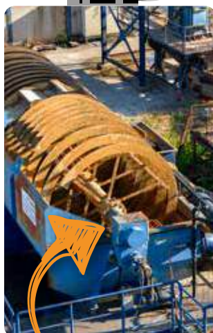
Spaltinjektion einer Rotorwelle in einer Kies-Waschanlage WEICON WR
