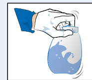
Se imersează banda de reparații în apă curată
