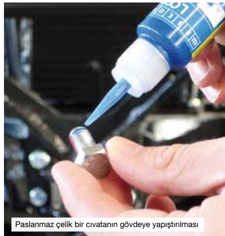
Bir baskı düzeneğinin vidalı bağlantısının yapıştırılması ve sabitlenmesi
