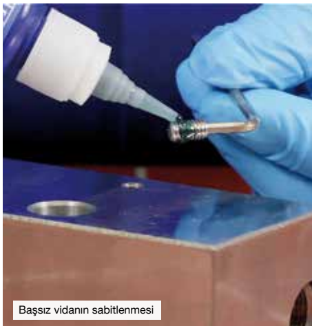
Paslanmaz çelik bir civatanın gövdeye yapıştırılması
