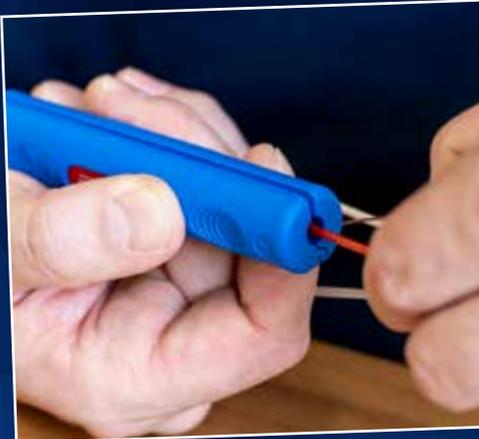
Utensile per la spelatura di connettori Buffer speciali in cavi in fibra ottica con un diametro di 1,2 / 4 mm. Funziona con manicotti centrali, ad es. in PE, con spessori delle pareti di 0,15-0,6 mm.
