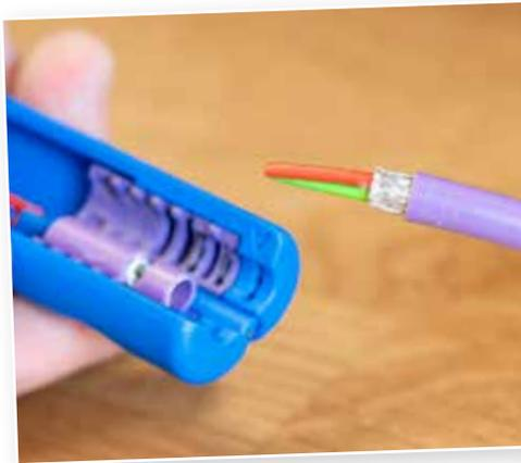
strumento di spelatura adatto per cavi dati Profibus schermati con un diametro da 5,5 mm a 8 mm, per esempio adatto per collegare i connettori FastConnect
