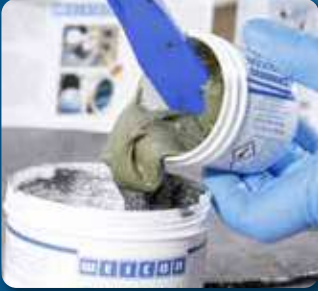
将固化剂倒入树脂
