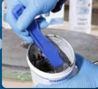
树脂与固化剂充分混合 避免气泡产生
