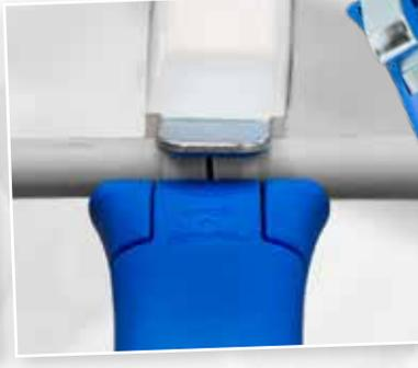
Nota: El trabajo con las herramientas pelacables WEICON sólo está permitido en cables y conductores libres de potencial, no en tensión.
