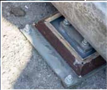
Speziell entwickelt für die Unter- und Hinterfüterung schwer auszurichtender Anlagen.
