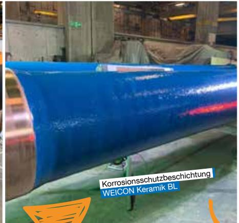
Korrosionsschutzbeschichtung WEICON Keramik BL
