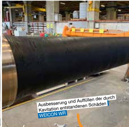
Ausbesserung und Auffüllen der durch Kavitation entstandenen Schäden WEICON WR
