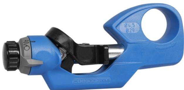
Das Kabelmesser No. 4-29 Spiral ist sehr robust, präzise und eignet sich sowohl für weiche als auch für harte Isolierungen von Kabeln mit einem Durchmesser von 4,5 - 29 mm. Die verschiedenen Schnittrichtungen für den Rund-, Spiral- und Längsschnitt lassen sich sicher über die jeweilige Rastposition mit dem Schalthebel einstellen. Durch den Spiralschnitt lassen sich auch komplexe Isolierungen einfacher entfernen.
