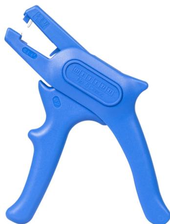
Die WEICON-Abisolierzange No. 5 Classic kann alle flexiblen und massiven Leiter von 0,2 – 6,0 mm<sup>2</sup> abisolieren. Ein gut zugänglicher Seitenschneider ist in das Werkzeug integriert, der bis zu einem Kabeldurchmesser von 2 mm genutzt werden kann. Die Klingen sind wechselbar. Das geringe Gewicht der No. 5 Classic sorgt für ein ermüdungsfreies Arbeiten.
