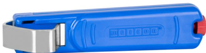
Das Kabelmesser No. C 8-27 ermöglicht ein präzises, schnelles und sicheres Entmanteln aller gängigen Rundkabel mit einem Durchmesser zwischen 8 und 28 Millimeter. Mit Hilfe einer Stellschraube am Griffende kann die Schnitttiefe des Schneidmessers stufenlos reguliert werden. Dies verhindert eine Beschädigung der inneren Leiter. Das Schneidmesser ist selbstdrehend im Gehäuse integriert und ermöglicht so die automatische Umstellung von Rund- auf Längsschnitt.
