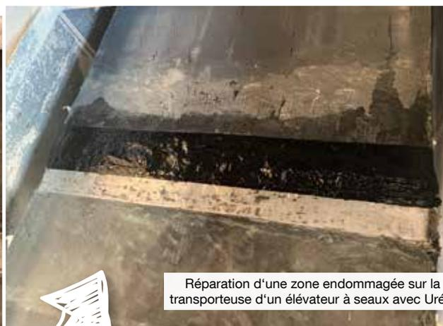
Réparation d'une zone endommagée sur la bande transporteuse d'un élévateur à seaux avec Uréthane 85
