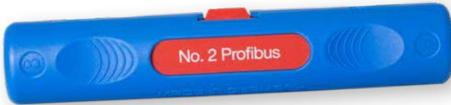
Abisolierwerkzeug für z. B. geschirmte Profibus-Datenkabel im Durchmesser von 5,5 mm bis 8 mm, z. B. zum Anschluss für FastConnect-Steckverbinder
