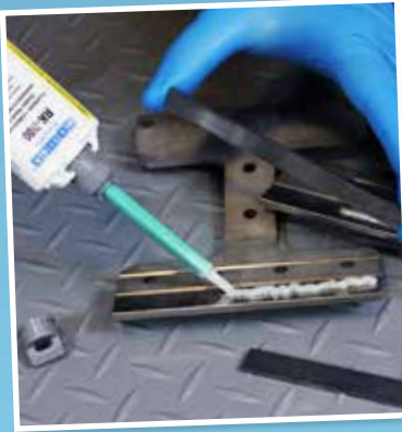
Pegado de un manguito en una boquilla de depósito RK-7000
