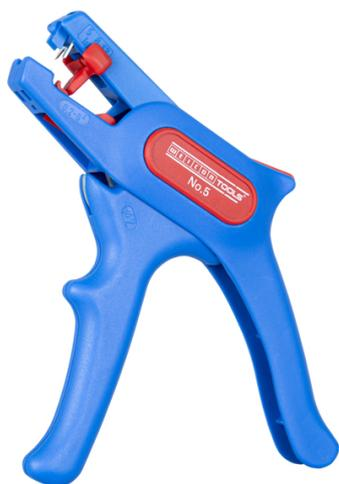
Die WEICON-Abisolierzange No. 5 kann alle flexiblen und massiven Leiter von 0,2 – 6,0 mm<sup>2</sup> abisolieren. Die Zange verfügt über einen verstellbaren Längenanschlag von 5 – 12 mm. Der Längenanschlag kann bei Bedarf herausgenommen werden. Ein gut zugänglicher Seitenschneider ist in das Werkzeug integriert, der bis zu einem Kabeldurchmesser von 2 mm genutzt werden kann. Die Klingen sind wechselbar. Das geringe Gewicht der No.5 sorgt für ein ermüdungsfreies Arbeiten.
