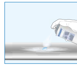
Sceller la zone réparée avec du zinc en spray
