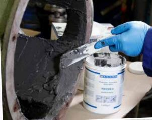
pâteux | chargé d'acier inox | homologué DNV | convient idéalement pour la réparation d'arbre rotatif
