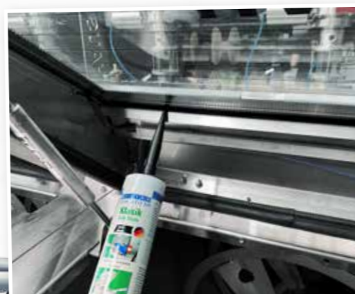
Lepení a utěsnění skleněného krytu (stroj na zpracování oliv) Flex 310 M® Classic
