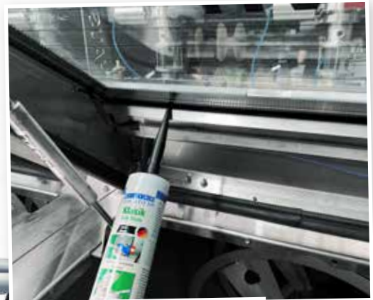
Pegado y sellado de una tapa de cristal (máquina procesadora de aceitunas) Flex 310 M® Clásico
