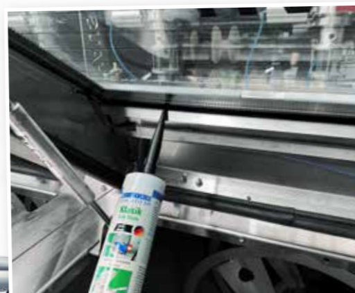
Lipirea și etanșarea unui capac din sticlă (utilaj de procesare a măslinelor) Flex 310 M® Classic
